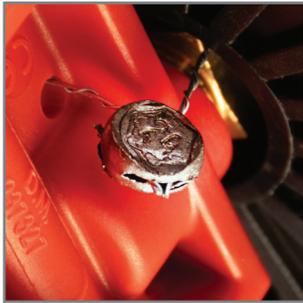
Zaplombovaný manometr splňuje požadavky na stanovená měřidla.
