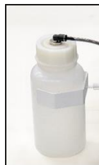
Obr. 5: Kontrola nádoby na zber kondenzátu
